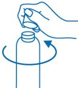
Montaggio della pompa dosatrice sul flacone:
